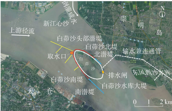
图 6 白茆沙水库布置及其与整治工程关系
