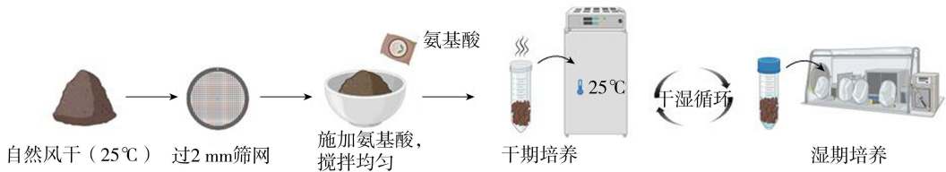
图 1 氮素转化试验过程
