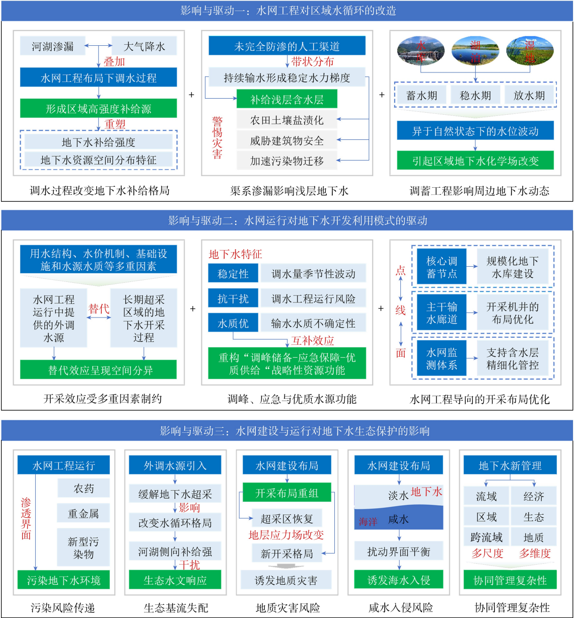
图 2 水网建设对地下水系统的影响与驱动机制
