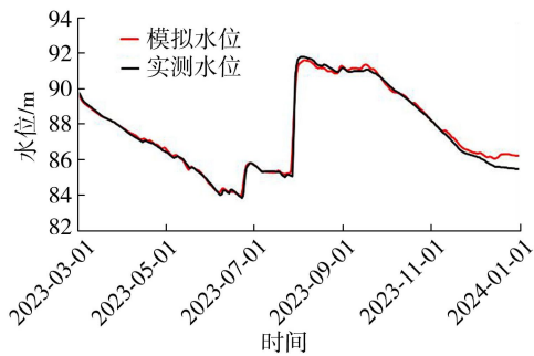
图4 EFDC模型钦寸库区水位验证结果
