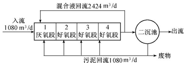
图 1 分段污泥回流工艺
