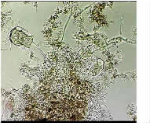
图 5 接种 5 d 颗粒污泥显微镜照片
