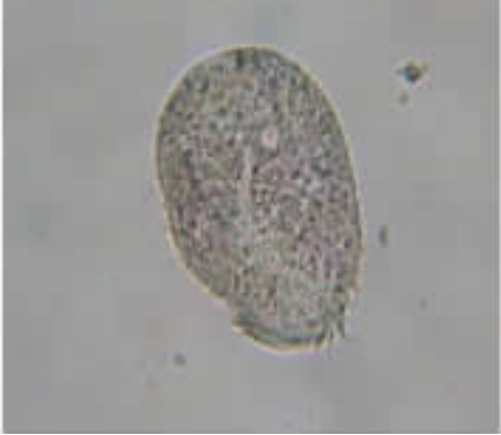
图 6 成熟好氧颗粒污泥显微镜照片
