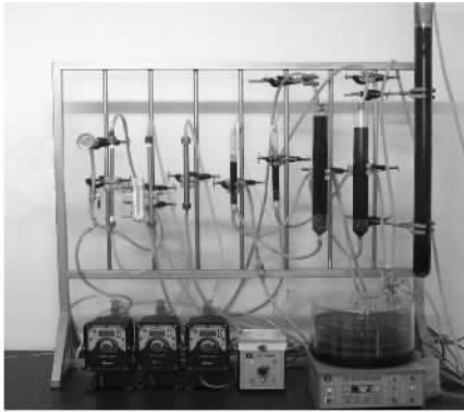
注 从左至右依次为 3 根 MCRB 柱(内径 5,5,8 mm),2 根微型柱(内径 15,15 mm),2 根小型柱(内径 36,36 mm) 柱下方依次为 3 台活塞泵,1 台蠕动泵,1 台自动取样器
