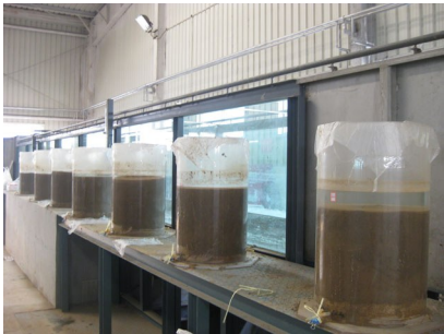
图 1 模拟含水层实验装置
