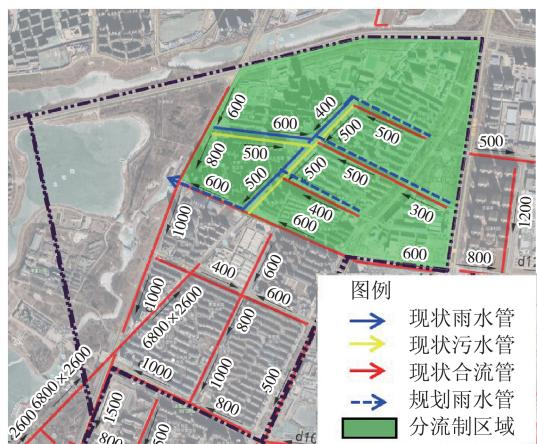
图 4 雨污分流改造示意图(单位:mm)
